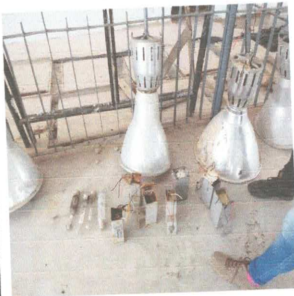
Foto 05: 1.3.0.20. Reatores para lâmpada vapor de mercúrio de 250w (07/10/22 a 11/10/22)
